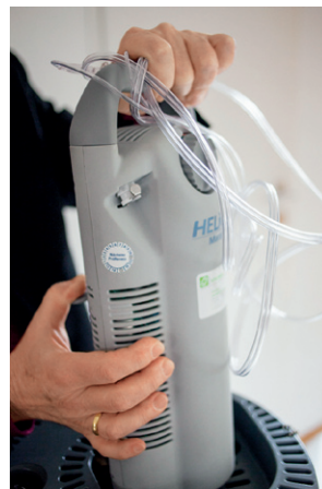
Sauerstoff-Tankstelle. Flüssigsauerstoff für tragbaren „Stroller“
